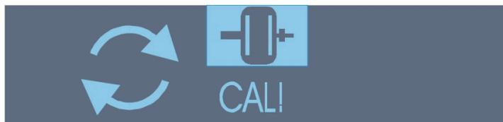
4. Faire tourner l'arbre de manière à atteindre une vitesse de rotation > 115 tr/min. Le cycle d'étalonnage commence lorsque les tours de l'arbre sont portés à la vitesse de 115 tr/min.
